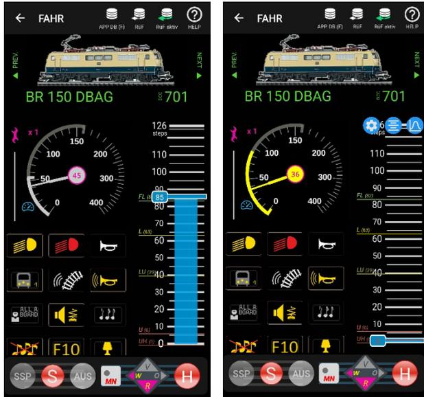
Dies ist der Bildschirm zum Steuern einer Lok (zukünftig auch für Traktionen und Züge); aufrufbar vom Bildschirm APP DB (F) oder RUF durch Touch auf eine Zeile (im Bereich Name, Adresse), oder auch durch Nutzung der von „PREV“ or „NEXT“ am FAHR-Bildschirm eines anderen Fahrzeugs Die **grundsätzliche Anordnung ist ähnlich** den **Fahrpulten MX32/MX33**.
