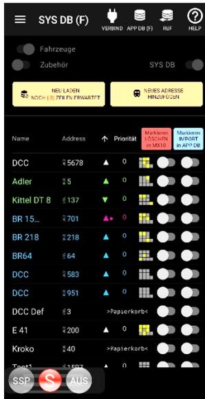
Die SYS DB (F) ist eine Wiedergabe der Objekt-Datenbank des Basisgerätes MX10, vorläufig nur Fahrzeugadressen bzw. Fahrzeuge, daher „(F)“. Sie enthält die gleichen Adressen und Daten wie bei Aufruf (durch E+6) der systemweiten Objekt-Datenbank (Fenster PU+SYS, früher ObjDB) am Fahrpult MX32 oder MX33 zu sehen sind. Die SYS DB wird entweder automatisch gefüllt (nach Start der App) oder durch Touch auf „NEU LADEN“.
