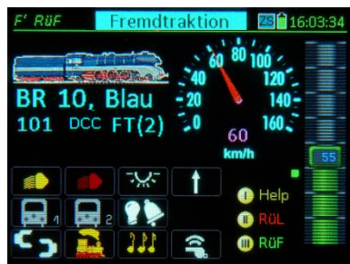
Auf einem anderen Fahrpult, also Nicht-Residenz-Gerät der Traktion „T5“ des obigen Beispiels. Beim Versuch, die zweite Traktions-Lok „BR 10 Blau“ zu aktivieren, erscheint die Meldung „Fremdtraktion“ und Markierung „FT“
