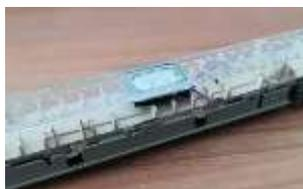
Der Einbau der MX605SL Platinen für vorne und hinten erfolgt wie abgebildet:
