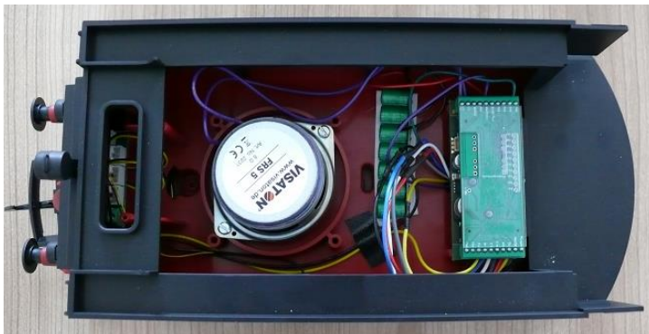
Tender mit eingebautem Decoder, Lautsprecher und Energiespeicher (violette Kabel auf „Ventilator“)
