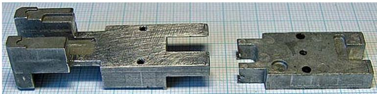
Das Gewicht wurde auf eine Dicke von 8.0 mm und auf eine Restlänge von 16.0 mm abgefräst (oder abgesägt). So erhält man den nötigen Platz für den Decodereinschub.
