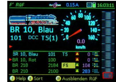
Scroll im **RÜF** zu „BR10 rot“, welche zweite Traktionslok werden soll, TP, 5, um diese mit „T5“ zu markie-
