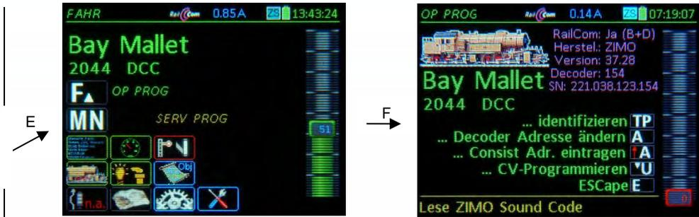
Bei Eintritt in den Betriebszustand **OP PROG** gelangt man zunächst in einen Auswahlbildschirm; OBEN ist die Situation dargestellt, bei der der Decoder **über RailCom rückmeldefähig** und damit „identifizierbar“ ist: Informationen wie Hersteller, SW-Version, und Decoder-ID werden automatisch ausgelesen und angezeigt (in der Farbe Magenta, der RailCom-Kennfarbe);
