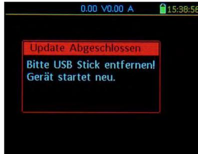
Nach dem Update wird die **Aufforderung zum Entfernen des USB-Sticks** angezeigt, danach erfolgt (immer) ein **automatisches Reset** und Hochfahren des MX32. Hochfahren des MX32.
