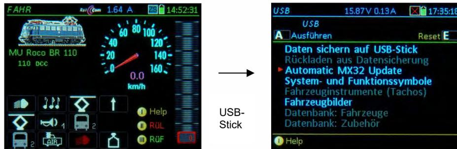
**A-Taste** → das „**Inhaltsverzeichnis**“ wird angezeigt: eine Liste mit den Einträgen (in Reihenfolge): „DATENSICHERUNG auf USB-Stick“, „RÜCKLADEN der Datensicherung“, „Automatisches MX32 Update“ und, danach die Bezeichnungen der ladefähigen Daten (nicht die Dateinamen selbst), sowohl der am Stick tatsächlich vorhandenen Daten (BLAU) als auch solcher, die NICHT auf diesem Stick vorhanden sind (GRAU), aber grundsätzlich sein können.
