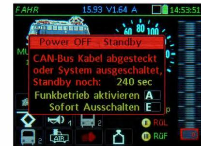
\*) Auch im Nicht-Funk-Fahrpult MX33 befindet sich ein **Akku** (kleiner als im MX33FU). Dieser dient auch zum Weiterbetrieb der Echtzeit-Uhr bei abgeschaltetem Fahrpult, sowie zur Zwischenspeicherung von Daten (z.B. Rückhol-speicher) für ca. ½ Jahr. Dies gilt für den Fall, dass der Akku nicht bereits durch mehrere Standby-Sequenzen entladen wurde.
