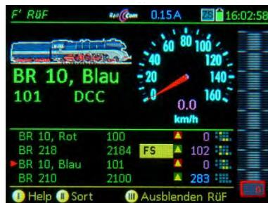
befinden und dürfen in keinem anderen Bediengerät aktiv gesteuert werden (also KEINE **FS** Markierung) oder bereits einer anderen Traktion angehören (also KEIN „T“ oder „F“).
