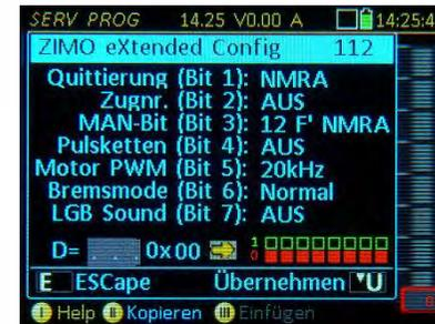
**HINWEIS:** die einzelnen Bits haben in vielen Fällen keine genormte Bedeutung, sondern sind abhängig vom Decoder-Hersteller. Daher gibt es die vollständigen Bezeichnungen bei einigen CVs nur, wenn zuvor eine Identifizierung (**TP-Taste**) stattgefunden hat, und es sich um einen ZIMO Decoder handelt.
