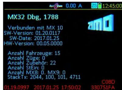
In all diesen Fällen der Inbetriebnahme läuft zunächst eine **Hochfahr-Sequenz** (ca. 10 sec). Am Bildschirm wird dabei (sehr schnell ...) ein Protokoll der gerade ausgeführten Aktivitäten gezeigt, das normalerweise (wenn's funktioniert ...) nicht beachtet werden muss.
