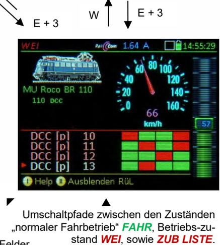
Umschaltpfade zwischen den Zuständen „normaler Fahrbetrieb“ **FAHR**, Betriebszustand **WEI**, sowie **ZUB LISTE**.
