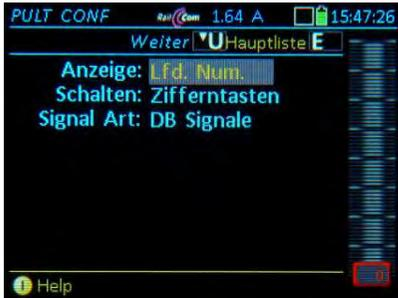
**Anzeige** = Lfd. Nummer: über den einzelnen Feldern werden laufende Nummern angezeigt (per ↑ (Shift) umschaltbar auf Adresse)
