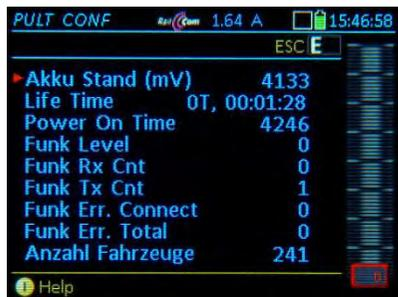
**Akku Stand (mV)**: Zeigt die aktuelle Akku-Spannung = > 3,8 V (3800 mV); Laden des Akkus = < 3,6 V (3600 mV); Akku wird entladen
